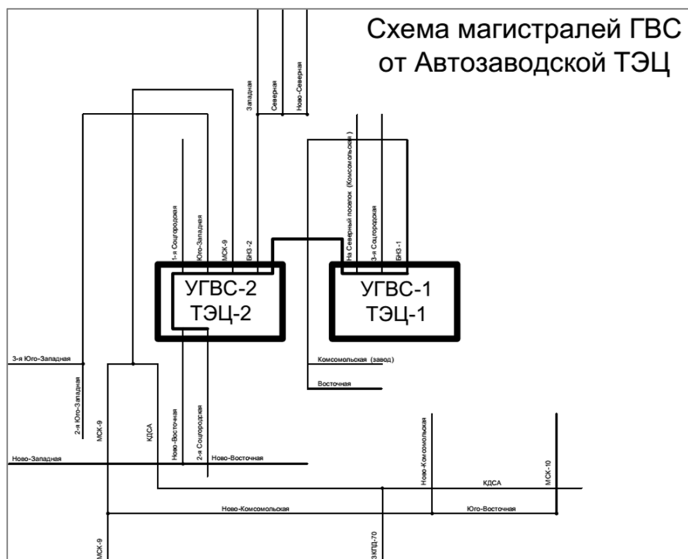
Рисунок 2.19 – Схема внешних магистралей ГВС от Автозаводской ТЭЦ
